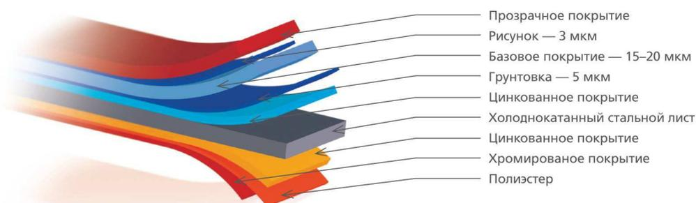
На поверхность обшивки сэндвич-панелей наносится защитная плёнка, обеспечивающая сохранность покрытия при перевозке и монтаже. Стеновые сэндвич-панели являются элементами полной заводской готовности и не требуют дополнительной отделки.
